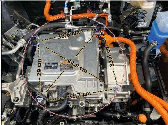
Die 4 Stehbolzen und die Gummilöcher mit etwas „Spüliwasser“ benetzen, damit die Gummis sich leichter eindrücken lassen. Den „frunkansbach“ auf die 4 Stehbolzen aufsetzen und im Bereich der 4 Schrauben in den Gummi eindrücken - auf vorne und hinten achten!
